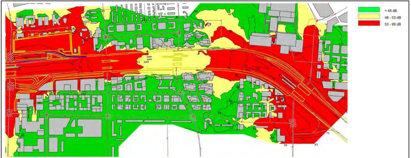
Figuur 10.1 Geluidcontouren A10 op 5 m hoogte met gebouwvolumes voor modelvariant 2 met dok (indicatief)
