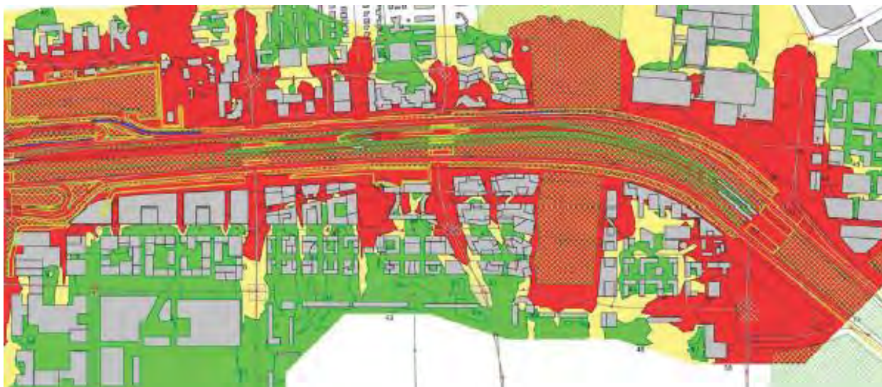
figuur 33 Wegverkeerslawaai A10 (verkeersgegevens 2020) met vulling van de plangebieden met gebouwen (rood betekent niet voldoen aan de Wet geluidhinder)
