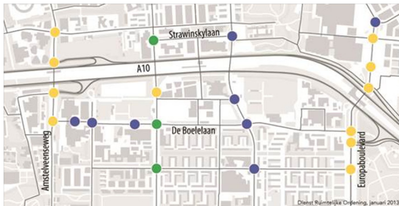
Figuur 1: Overzicht verkeerslichten Zuidas -blauw: niet aangesloten op KWC -geel: onnauwkeurige data -groen: bruikbare data
